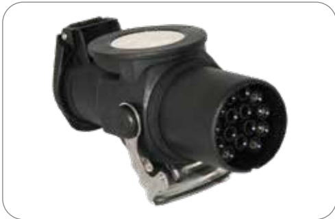
Kurzadapter mit 15P/24V Stecker (ISO 12098) und 7P/24V Steckdose (ISO 1185) Short adapter with 15P/24V plug (ISO 12098) and 7P/24V socket (ISO 1185)
