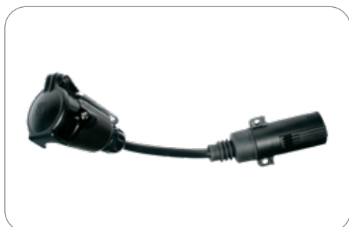
Kurzadapter-Leitung mit 7P/12V Stecker (SAE J560) und 7P/12V Kupplungsdose (ISO 1724)
